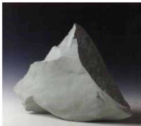
Il reticolo cristallino della zeolite è composto da **SiO<sub>4</sub>- e AlO<sub>4</sub>-Tetraedri**, uniti tra loro da ponti di ossigeno. Ne deriva che arriva a formarsi una complessa disposizione di cavità regolari aventi una dimensione dei pori di 4 angstrom. In questo reticolo cristallino si trovano cationi come calcio, magnesio, sodio, potassio e simili, in combinazione con l'acqua.
