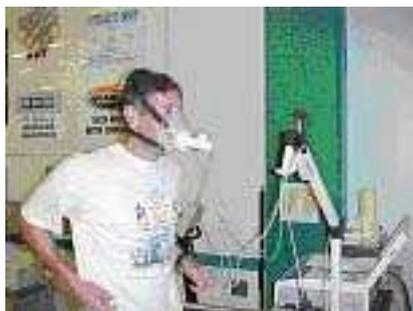
**Figure 4: Atleta collegato ad un analizzatore di gas, mentre si sta sottoponendo ad un test**
